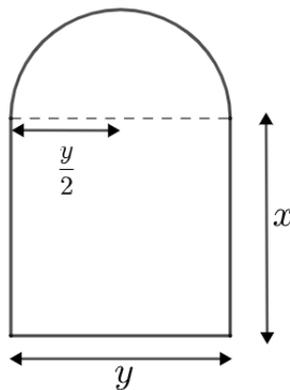
Pour garantir un gain maximal dans la production, cette pièce doit avoir le plus petit périmètre possible. Mais pour des raisons technique aussi, la surface de cette pièce doit être  $c = 2$ . Donc quels sont les longueurs optimales de  $x$  et  $y$ .
